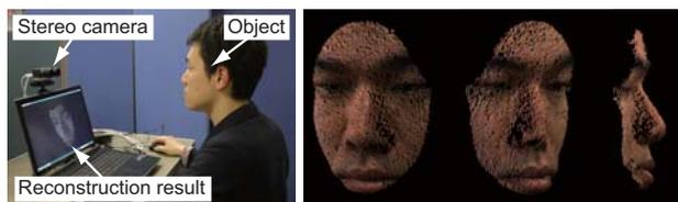
図2: リアルタイム3次元計測システム
